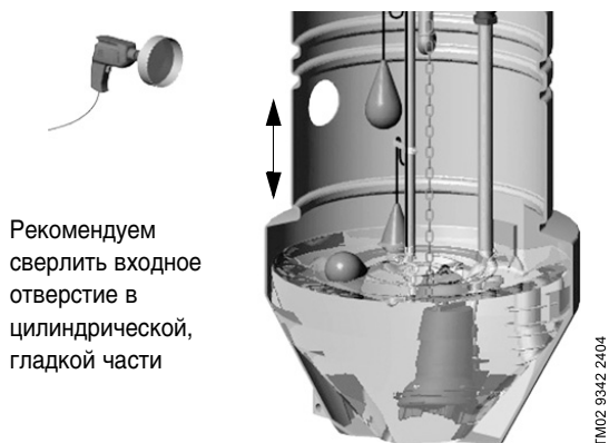
Рис. 14 Обработка отверстия под подводящий трубопровод
