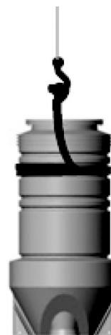
Рис. 10 Способы подъема станции
